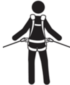
E- Elemento de fijación de cadera
